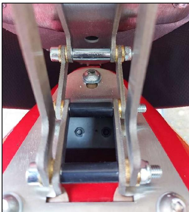
**Schritt 3:** Die Sitzbank zusammen mit dem Scharnier mit drei M8x20 Sechskantsschrauben und Unterlegscheiben am Rahmen verschrauben.
