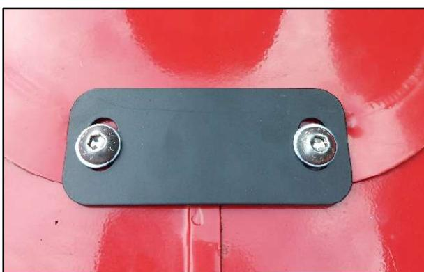
**Schritt 4:** Die Rahmenplatte für den Magnet mit zwei M8x20 Schrauben und Unterlegscheiben hinten am Rahmen hinten verschrauben.
