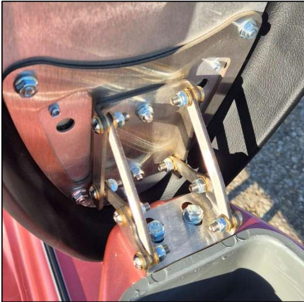
**Schritt 2:** Um die Höhe des Rahmenfalzes auszugleichen, das Scharnier mit 2 x M7 Unterlegscheibe über den Gewindelöchern am Rahmen unterfüttern. Anschließend das Scharnier mit 2 x M7x20 Sechskantschraube und 2 x M7 Unterlegscheibe am Rahmen verschrauben.
