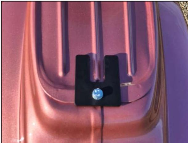
**Schritt 3:** Die Rahmenplatte für den Magnet mit einer M7x20 Sechskantschraube und M7 Unterlegscheibe verschrauben.
