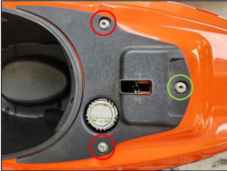
**Schritt 3:** Die beiden dicken Kunststoffspacer rechts und links unter der Kunststoffabdeckung verschrauben (rote Markierung). Den flachen Spacer hinten verbauen (grüne Markierung).
