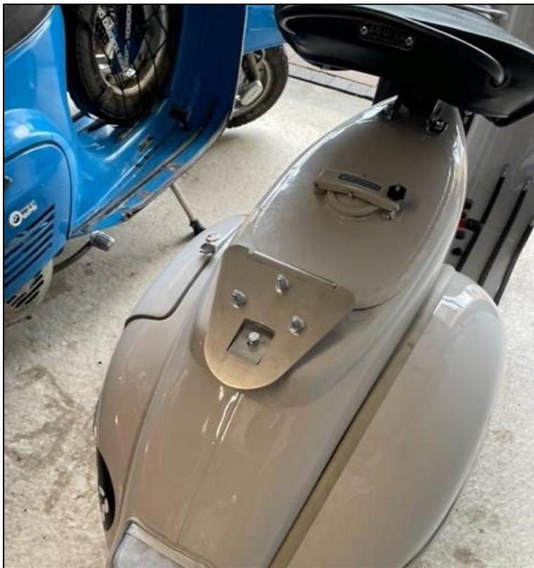
**Schritt 3:** Den Halter mit den drei M7x20 Schrauben und 7er Unterlegscheiben am Heck der Vespa verschrauben.
