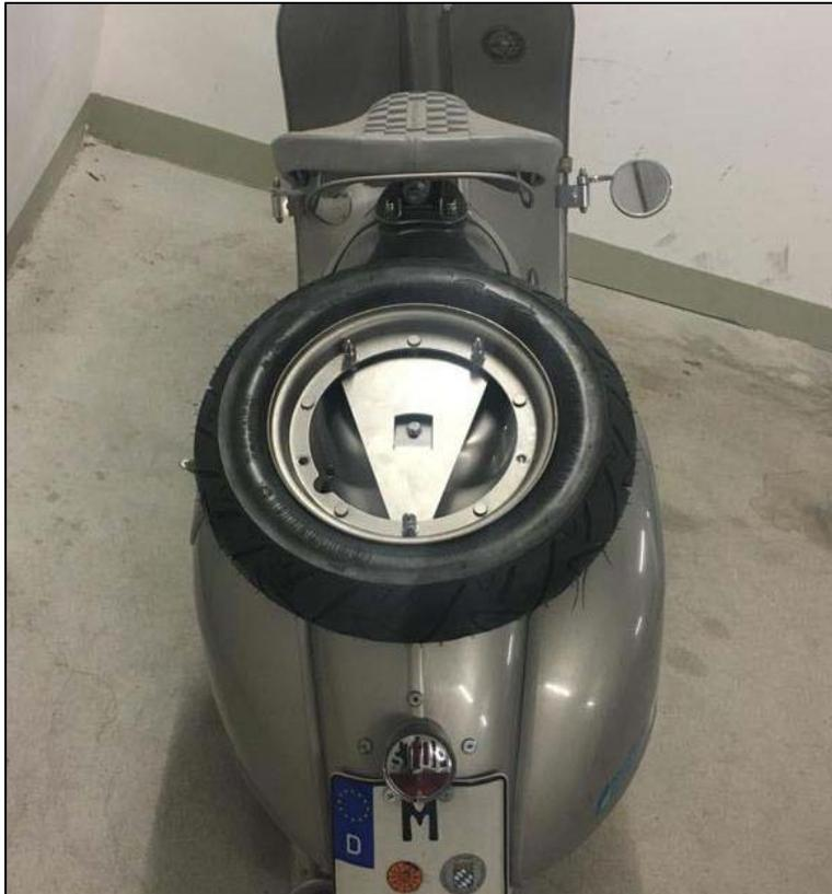
**Schritt 4:** Drei 8er Unterlegscheiben auf die herausstehenden M8er Schrauben stecken und das Reserverad auf die Schrauben aufsetzen. Ersatzrad anschließend zusammen mit den 8er Unterlegscheiben und M8er Muttern am Halter verschrauben.
