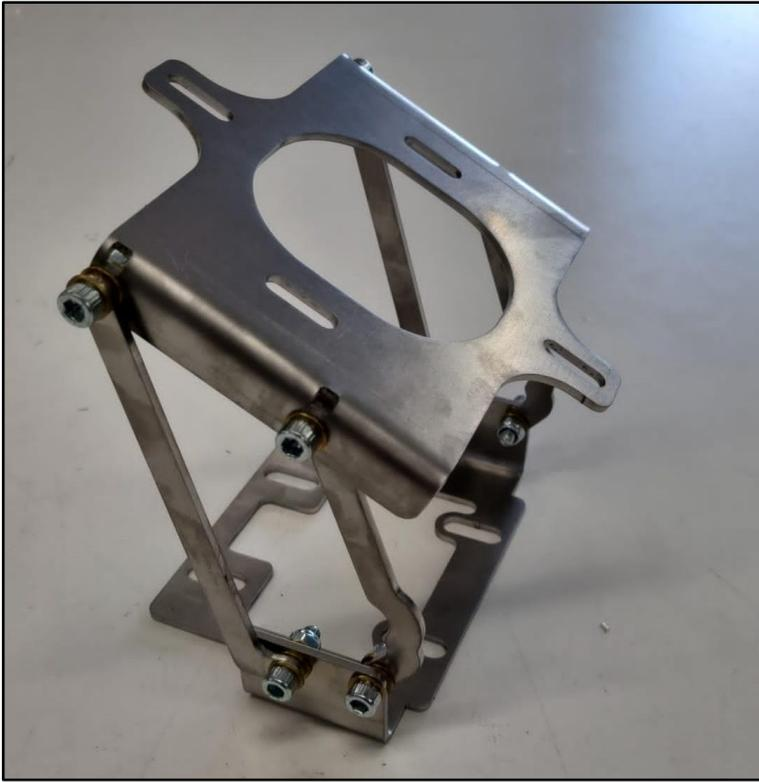
**Schritt 2:** Alle vier Hebel an der oberen Sitzbankplatte mit Hilfe der M6x20 Inbusschrauben, jeweils drei Messingscheiben sowie einer selbstsichernden Mutter M6 verschrauben.
