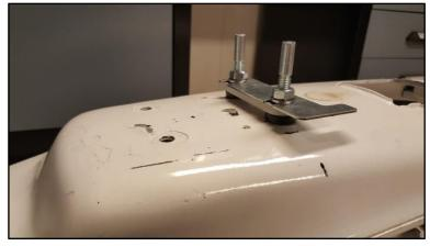
Schritt 8:Die beiden M8er Muttern auf die M8x55 Gewindestifte aufschrauben und diese zusammen mit den Unterlegscheiben, dem Verriegelungsblech, der Alu-Rahmenplatte, den beiden Kunststoffspacern sowie den selbstsichernden Muttern laut Bild links an der Hinterseite des Rahmens verschrauben.
