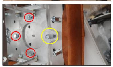
Schritt 3:Vorne das fertig zusammengebaute Scharnier mittig einsetzen und mit Hilfe von 3 x M6 Flanschmuttern mit Sperrverzahnung (Rote Markierung) verschrauben Ganz vorne eine M6x20 Distanzmuffe mit M6 Federring verbauen (Gelbe Markierung)
