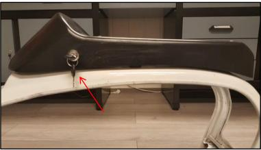
Schritt 9:Sitzbank zuklappen und von außen mit einer Taschenlampe durch den seitlichen Schlitz leuchten. Schloß verriegeln und dabei prüfen, ob die Schlosslasche nach dem Verriegeln unterhalb des Verriegelungsblechs sitzt. Ggf. Position des Verriegelungsblechs anpassen.
