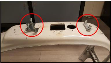
**Schritt 6:**Altes Befestigungssystem am Rahmen entfernen
