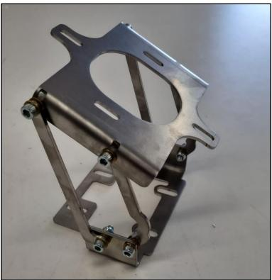
Schritt 2: Alle vier Hebel an der oberen Sitzbankplatte mit Hilfe der M6x20 Inbusschrauben, jeweils drei Messingscheiben sowie einer selbstsichernden Mutter M6 verschrauben. Ausrichtung der Sitzbankplatte: siehe Bild links
