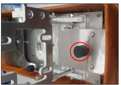
Schritt 11:Vorne durch den Spalt zwischen Sitzbank und Rahmen schauen und den vorderen Gummipuffer soweit herausdrehen, bis dieser auf dem Rahmen aufliegen.
