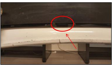
Schritt 10:Die zwei seitlichen Puffer von außen so weit herunterschrauben, bis diese auf dem Rahmen aufliegen. Höhe der Puffer anschließend mit den unter dem Puffer sitzenden Kontermuttern fixieren. Testen ob sich die Sitzbank anschließend noch einwandfrei abschließen lässt. Höhe des hinteren Puffers ebenfalls so weit anpassen dass dieser auf dem
