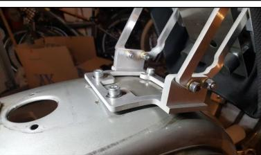
Schritt 7:Sitzbank mit aufgeklapptem Scharnier zusammen mit den M8x40 Inbusschrauben, Unterlegscheiben, sowie den selbstsichernden Muttern laut Bild links an der Vorderseite des Rahmens verschrauben. Dabei die Grundplatte des Scharniers an allen vier Punkten mit jeweils zwei M8er Unterlegscheiben unterbauen.
