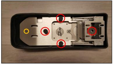
**Schritt 5:**Deckblech einsetzen. Gummipuffer zusammen mit einer M6er Unterlegscheibe einschrauben (rote Markierungen):
