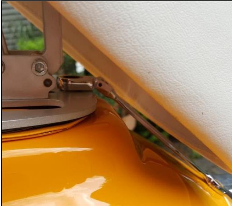
**Schritt 8:** Gelenkgabelschlüssel zum Einschrauben der hinteren Schraube verwenden.
