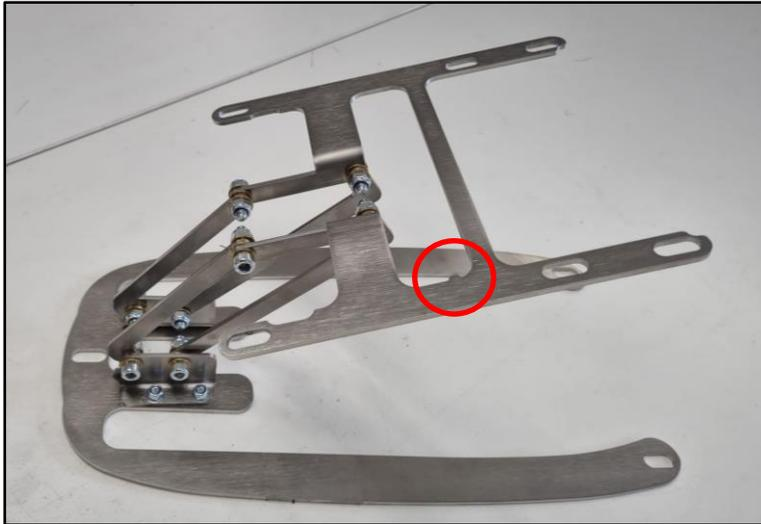
**Schritt 3:** Alle vier Hebel mit den M6x20 Inbusschrauben, Messing-Unterlegscheiben und selbstsichernden Muttern an der Sitzbankplatte verschrauben. Pro Schraube drei Messing-Unterlegscheiben zwischen Schraube, Blech und Hebel verbauen. Ausrichtung der Sitzbankplatte: siehe Bild links. Die Nocke muss nach rechts zeigen.
