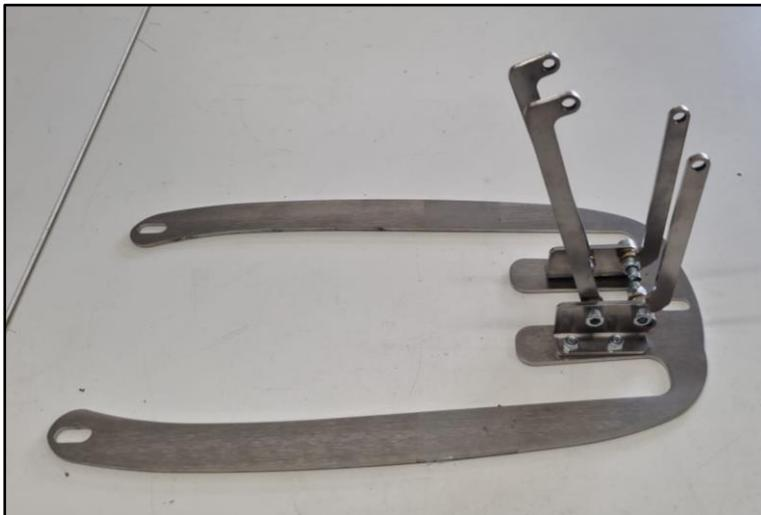
**Schritt 2:** Vorne die beiden langen und hinten die beiden kurzen Hebel mit den M6x20 Inbusschrauben, Messing Unterlegscheiben und selbstsichernden Muttern verschrauben. Pro Schraube drei Messing-Unterlegscheiben zwischen Schraube, Blech und Hebel verbauen. Die beiden Zylinderstifte in die gewinkelten Rahmenbockbleche einsetzen (Anschlag für die kurzen Hebel).
