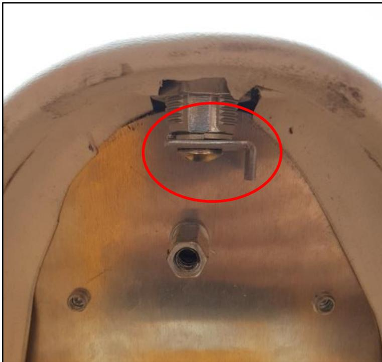
**Schritt 3:** Gummipuffer, Schrauben und Deckblech der Sitzbank entfernen.
