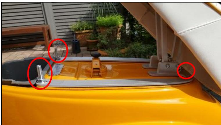
**Schritt 7:** Scharnier mit daran befestigter Sitzbank am Rahmen verschrauben. Vorne dabei die M7 Gewindestifte mit M7 Unterlegscheiben und M7 Muttern verwenden. Hinten die M7x20 Sechskantschraube mit Unterlegscheibe verbauen.
