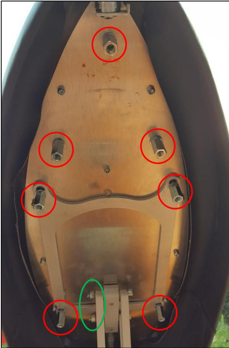
**Schritt 9:** Bänke der V2.0: Die drei M6x20 Distanzmuffen zusammen mit den Unterlegscheiben und Sprengringen an der Spitze der Sitzbank verschrauben.
