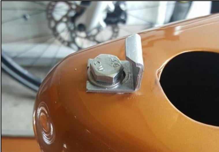
**Schritt 4:** Neuen Rahmenwinkel mit der M7x20 Sechskantschraube und Unterlegscheibe am Rahmen verschrauben. Winkel beim Anziehen der Schraube mit einer Zange fixieren. Ausrichtung des Winkels beachten (siehe Bild links).
