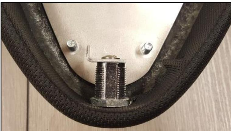
**Schritt 8:** Mit einem passenden Gabelschlüssel den Schlosszylinder fixieren und mit einem großen Schlitz-Schraubenzieher (kein Kreuz!) die Schraube der alten Schlosslasche lösen. Schlosslasche entfernen. Anschließend die Überwurfmutter lösen und das Schloss entfernen. Neue Schlosslasche gemäß Bild links montieren.
