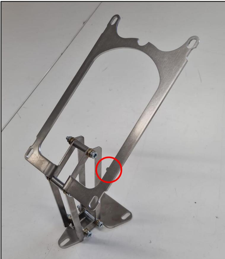
**Schritt 3:** Alle vier Hebel an der oberen Sitzbankplatte mit zwei M6x55 Inbusschrauben, jeweils drei Messingscheiben sowie einer selbstsichernden Mutter M6 verschrauben. Zwischen die Schrauben die beiden Metall-Distanzhülsen einsetzen. Ausrichtung der Sitzbankplatte: siehe Bild links. Die Nocke muss sich dabei auf der rechten Seite befinden.
