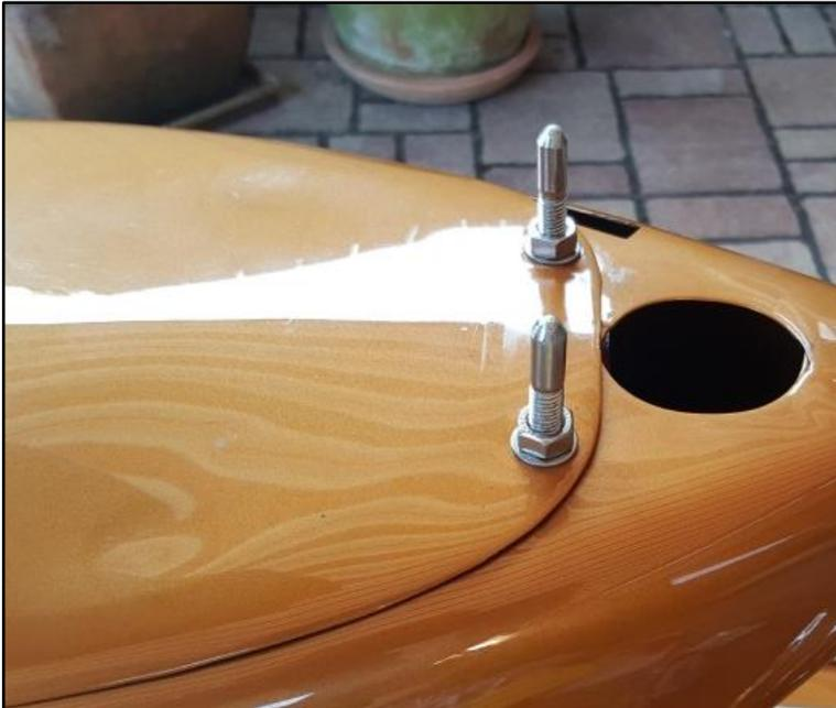
**Schritt 5:** Die beiden M7er Gewindestifte zusammen mit den Unterlegscheiben und Muttern ca. 10 mm an der Vorderseite des Tanks verschrauben. Anschließend die Gewindestifte mit den Muttern fixieren.
