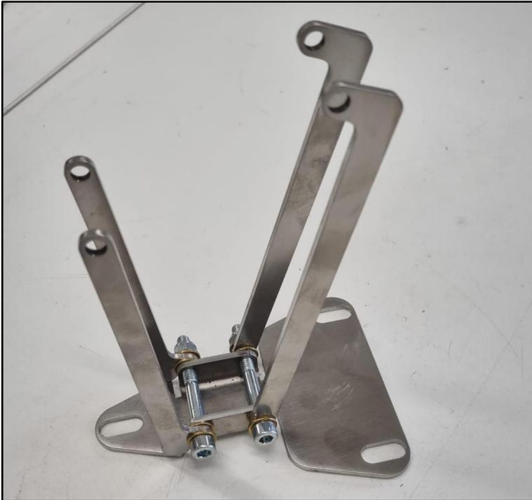
**Schritt 2:** Hinten die beiden langen Hebel mit einer M6x55 Inbusschraube, jeweils vier Messingscheiben sowie einer selbstsichernden Mutter M6 an der Rahmenplatte verschrauben. Ausrichtung der Hebel: siehe Bild links
