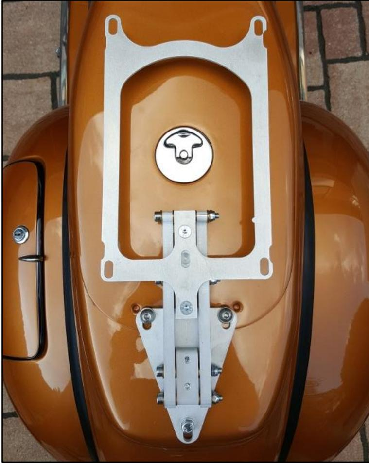
**Schritt 3:** Scharnier mit Hilfe der M7x20 Sechskantschrauben und Unterlegscheiben am Rahmen befestigen. Das Scharnier hinten gegebenenfalls mit entsprechenden Unterlegscheiben horizontal ausrichten.
