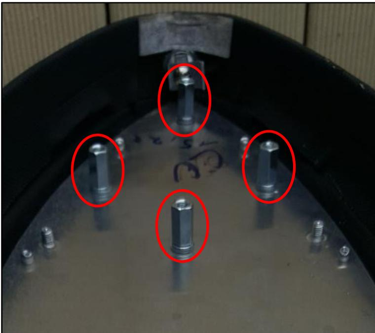
**Schritt 6:** Die fünf Gummipuffer sowie das Deckblech der Sitzbank entfernen.
