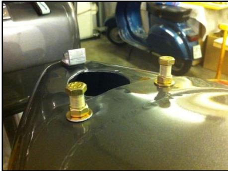
**Schritt 5:** Die vier M7x40 Sechskantschrauben zusammen mit den Muttern und Unterlegscheiben an der Vorder- und Hinterseite des Tanks einschrauben. Kontermuttern leicht fixieren.
