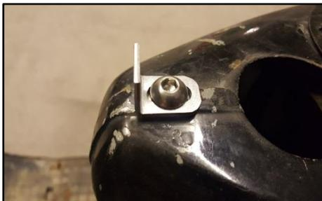
**Schritt 8:** Den Verriegelungswinkel zusammen mit der M7x20 Sechskantschraube und M7 Unterlegscheibe laut Bild links am Rahmen verschrauben. Winkel mit Hilfe des Langloches ganz nach vorne verschieben und mit der Inbusschraube die Position fixieren.
