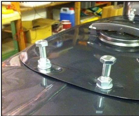
**Schritt 6:** Nun die Bank an der Spitze sowie am Heck anheben und das eventuell vorhandene Vertikalspiel durch Verringern der Schraubenhöhe minimieren. Anschließend die Höhe der Schrauben mit den Kontermuttern fixieren.
