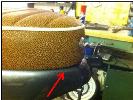
**Schritt 7:** Vorne durch den Spalt zwischen Sitzbank und Rahmen schauen und die beiden vorderen Gummipuffer soweit herausdrehen, bis diese knapp über dem Rahmen sitzen (Sitzbank muss sich noch aufschieben lassen).
