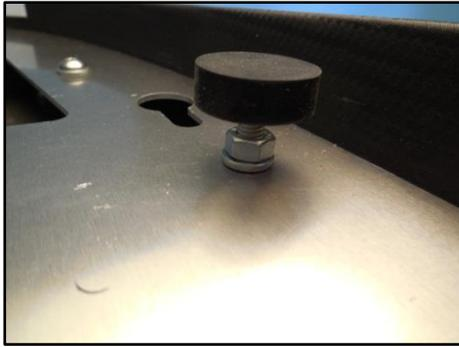
**Schritt 4:** Sitzbank auf den Rahmen aufsetzen und die Höhe der mittleren und hinteren Gummipuffer gleichmäßig so einstellen, dass die Bank umlaufend minimal Luft zum Rahmen hat und gerade sitzt.
