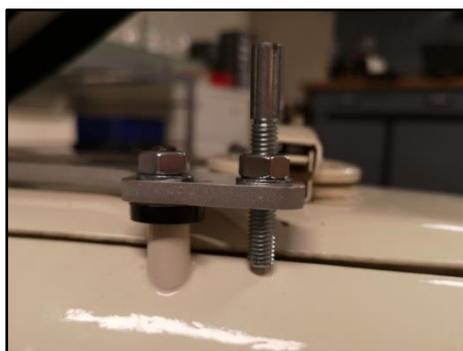
**Schritt 3:** Die beiden M8x50 Gewindestifte zusammen mit den Kunststoff-Spacern, den M8er Muttern und Unterlegscheiben auf der Rahmenplatte des Scharniers ca. 20 mm tief verschrauben. Hinweis: Das überstehende Gewinde kann ggf. unten gekürzt werden.
