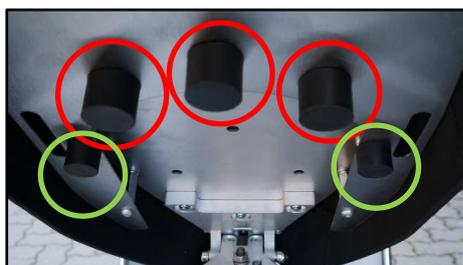
**Schritt 4:** Höhe der drei rot markierten Gummipuffer so einstellen, dass alle Puffer Kontakt zum Rahmen haben. Die beiden grün markierten Puffer komplett eingeschraubt lassen.
