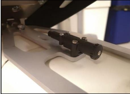
**Schritt 5:** Auf der Grundplatte des Scharniers kann nach Bedarf noch ein Polini Ziehchoke verbaut werden.
