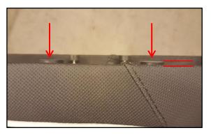
**Schritt 3:** Höhe der vier Gummipuffer so einstellen, dass diese ca. 2-3 mm über die Sitzbank hinausragen. Höhe der Schrauben mit den Kontermuttern fixieren.
