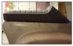
**Schritt 4:** Sitzbank testweise auf den Rahmen aufsetzen. Der Luftspalt zum Rahmen sollte ca. 5 mm betragen. Ggf. die Höhe der Sitzbank mit Hilfe der Gummipuffer einstellen.
