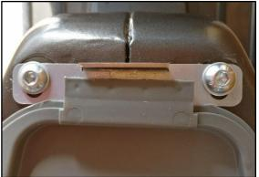
**Schritt 7:** Das vordere Verriegelungsblech zusammen mit den M8x20 Inbus Linsenschrauben und Unterlegscheiben laut Bild links am Rahmen verschrauben.
