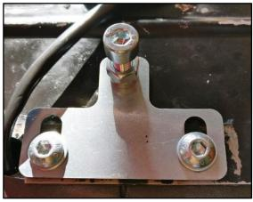
**Schritt 6:** Die M8x25 Inbusschraube zusammen mit der Kontermutter in die Gewindehülse des links abgebildeten Blechs einsetzen. Anschließend das Blech mit Hilfe der Inbus Linsenschrauben an der Hinterseite des Tanks befestigen.
