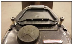
**Schritt 5:** Die beiden M8x40 Inbusschrauben zusammen mit den Muttern und Unterlegscheiben einsetzen. Kontermuttern leicht fixieren.
