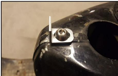
**Schritt 8:** Den Verriegelungswinkel zusammen mit der M8x20 Inbus-Linsenschraube an der vorderen Sitzbankbefestigung laut Bild links am Rahmen verschrauben. Winkel mit Hilfe des Langloches ganz nach vorne verschieben und mit der Inbusschraube die Position fixieren.
