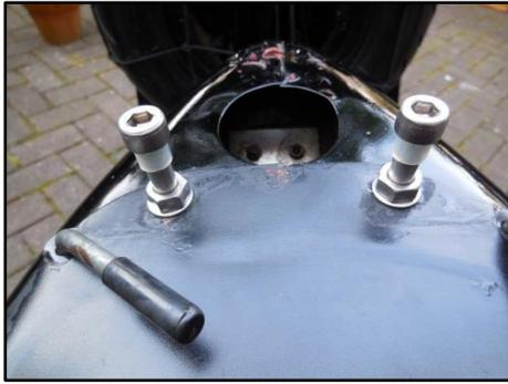
**Schritt 5:** Die vier Inbus- Zylinderschrauben zusammen mit den Muttern und Unterlegscheiben an der Vorder- und Rückseite des Tanks einschrauben (M8x40 vorne und M8x50 hinten). Kontermuttern leicht fixieren.
